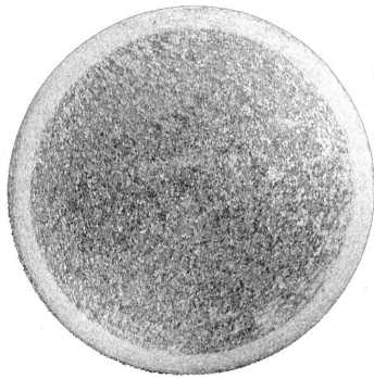
Рис. 2. Макроструктура поперечного перерізу вихідної заготовки зі сплаву АК6 з крупнокристалічним обідком
