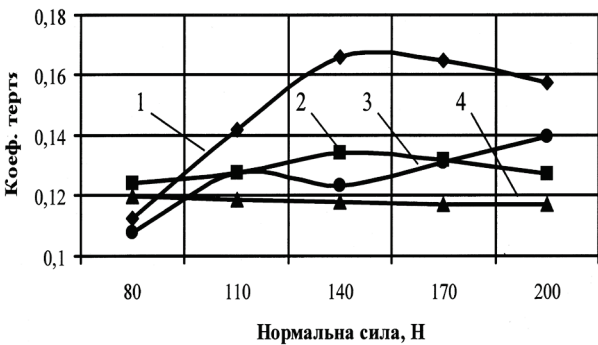
Рис. 4. Залежність статичного коефіцієнта тертя пари підшипник ковзання – вал-шестірня від нормальної сили: 1 – сухе тертя за наявності покриття на підшипнику; 2 – сухе тертя підшипника без покриття; 3 – тертя підшипника з покриттям за наявності мастила; 4 – тертя підшипника без покриття за наявності мастила
