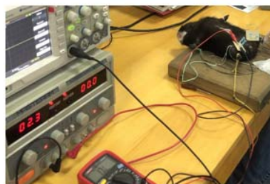
Рисунок 4.6 – Лабораторна установка для вимірювання імпедансу БТ
