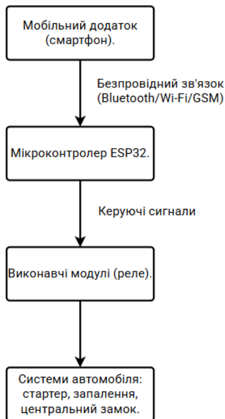
Рисунок 1 – Структурна схема віддаленого керування транспортним засобом
