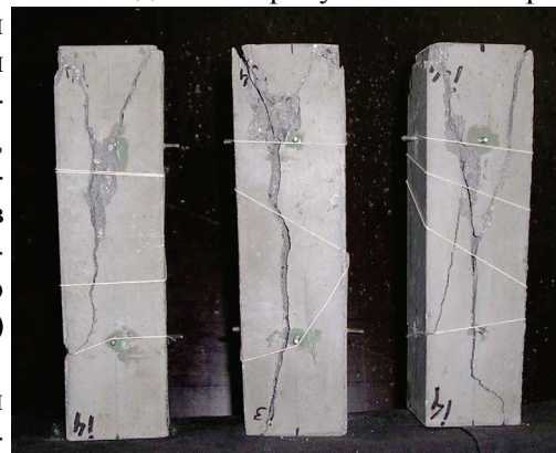
Рис. 2. Характер руйнування бетонних зразків
