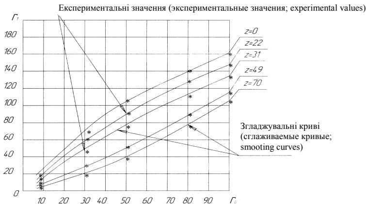
Рис. 3. Графіки сплайн-функцій, отримані для значень вагових коефіцієнтів, що відповідають похибкам вимірювань \delta_i \leq 0,01
