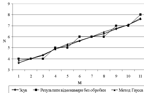
Рис. 4. Залежність пікселя відеокамери від пікселя монітора
