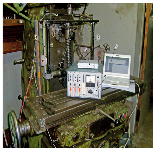
Рис. 4. Програмно-апаратний комплекс дослідження моделі підвіски на основі ЧЛВМ
