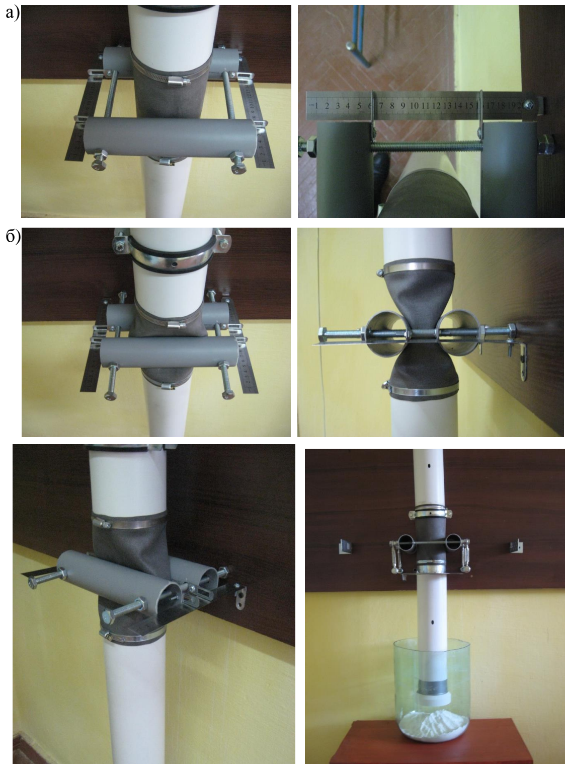
Рисунок 3.4 – Конструктивне виконання регулювального пристрою з зручнообтічними виконавчими елементами (фото): а) неробоче положення; б) робоче положення
