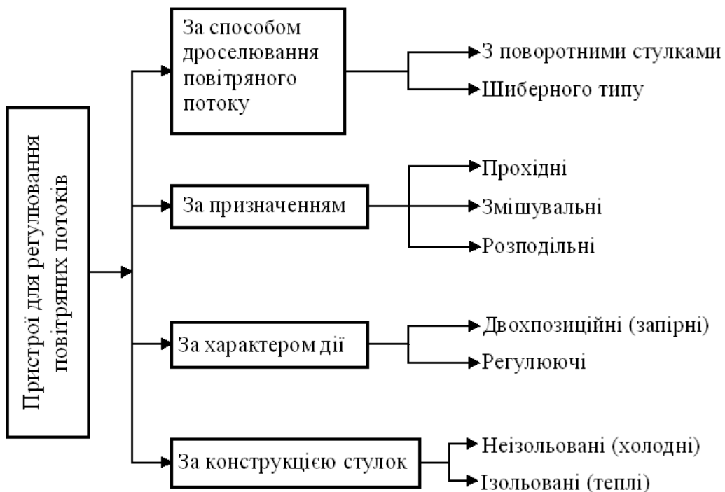
Рисунок 1.1 – Класифікація пристроїв для регулювання повітряних потоків
