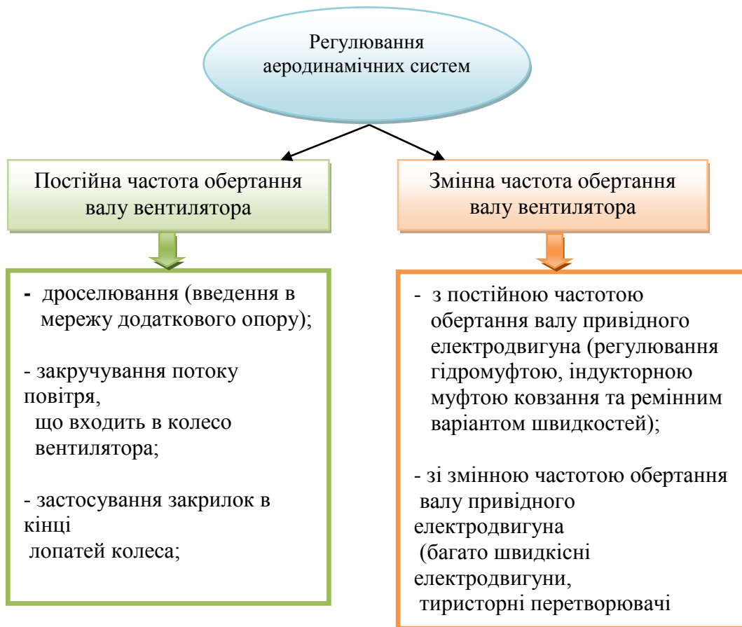
Рисунок 1.2 – Способи регулювання продуктивністю вентиляційних установок
