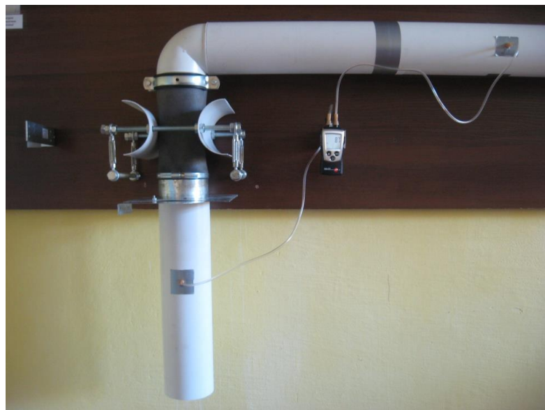
Рисунок 3.20 – Експериментальна установка з дослідження впливу роботи регулювального пристрою на втрати тиску в коліні
