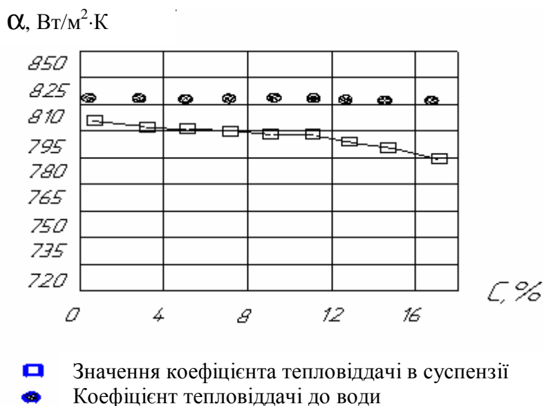
Рисунок 2.5 – Залежність коефіцієнта тепловіддачі від концентрації сухої речовини
