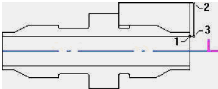
Рисунок 3.7 – Схема зміни положення початку системи координат
