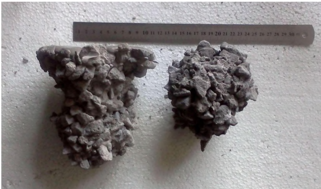
Рисунок 2 - Типові експериментальні зразки тіл заповнення утворені при імпульсному та статичному нагнітанні розчинів, відповідно
