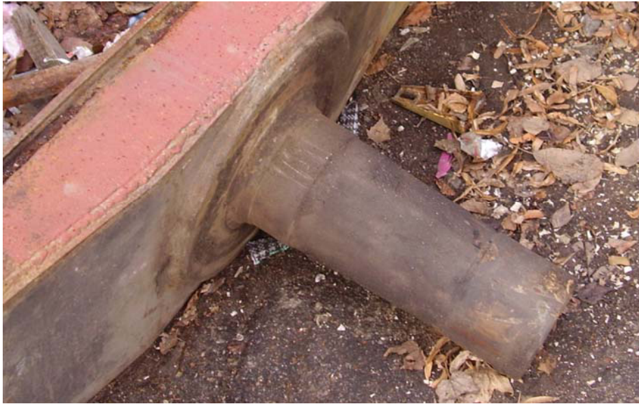
Рисунок 2 – Вирізана балка трамваю з пошкодженим шкворнем
