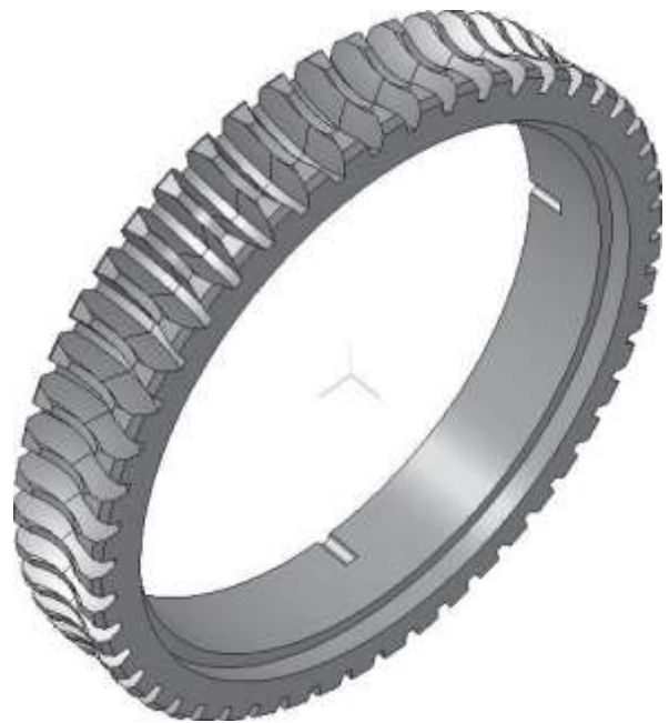
Рисунок 5.5 - 3D-модель обода черв'ячного колеса
