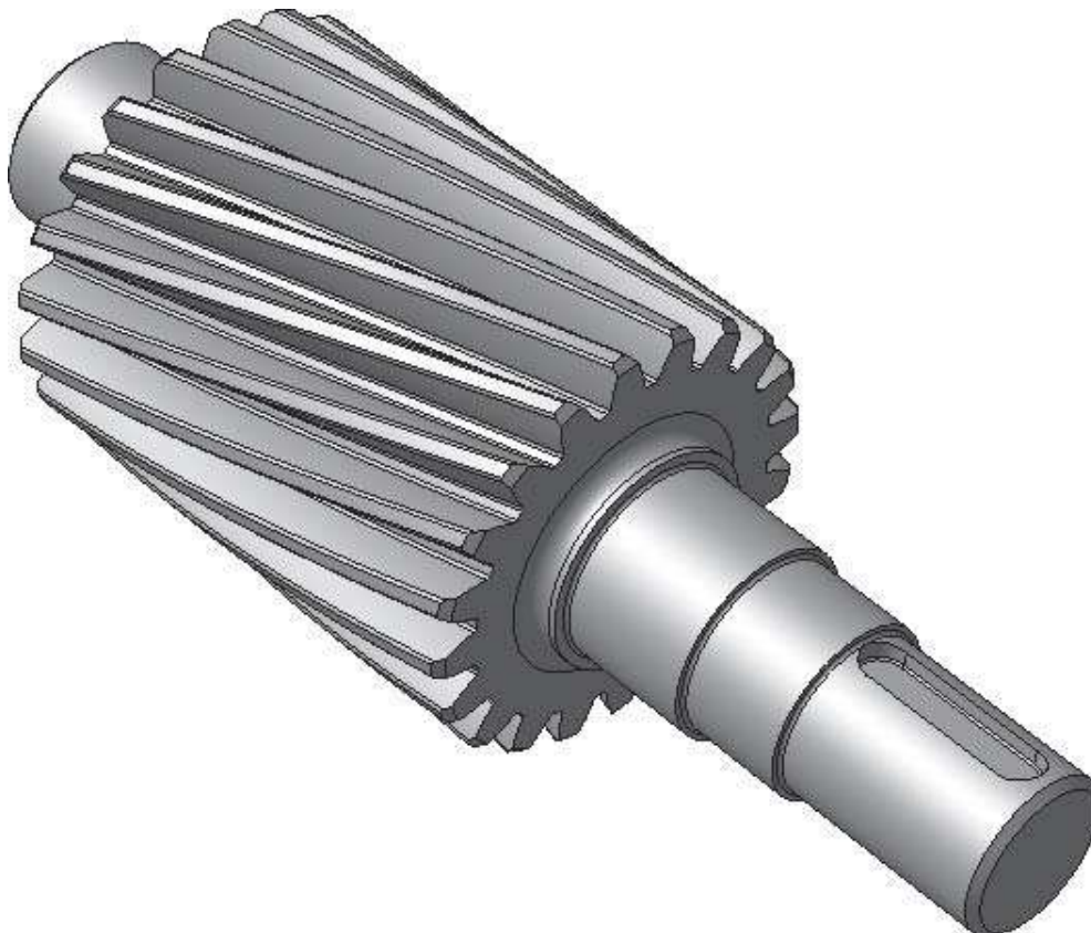
Рисунок 3.5 – 3D-модель ведучого вала-шестерні
