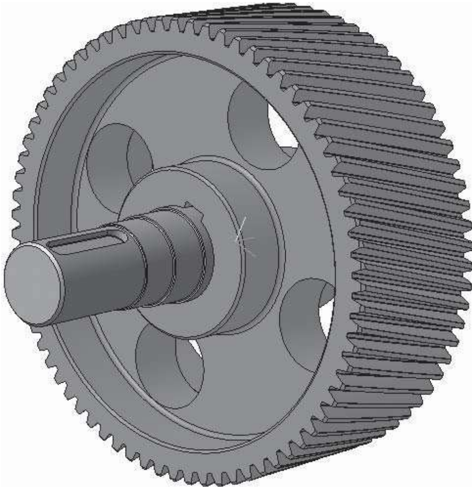
Рисунок 9.1 – Вставка веденого вала в збірку
