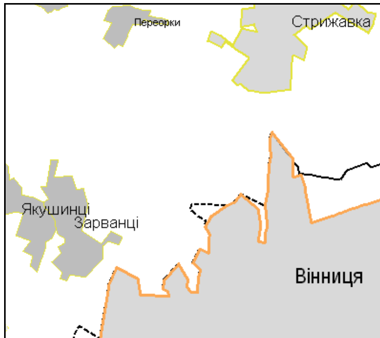
Рисунок 3.6 — Збільшений фрагмент векторної карти «Населені пункти», виведеної спільно з картою «Границі», де добре видно використані умовні позначення для позначення міст (Вінниця), смт. (Стрижавка) та селищ, а також видно які підписи використовуються для міст, смт. та селищ.
