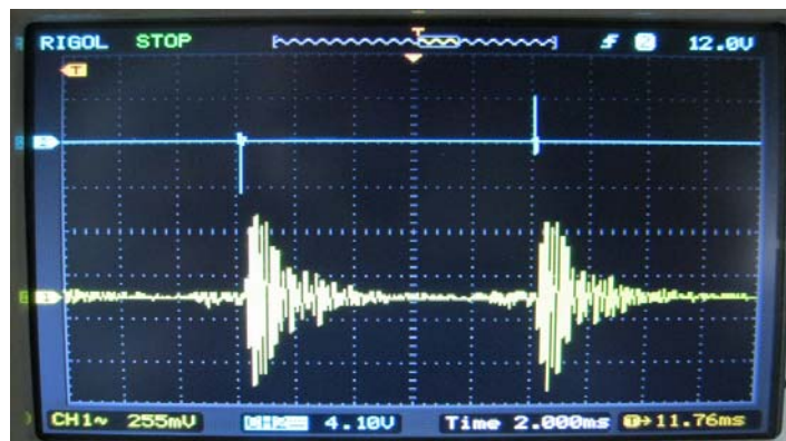
Рис. 3. Реакція електромеханічної системи на збурення імпульсним сигналом: канал № 1 — сигнал з датчика прискорення; канал № 2 — сигнал на виводах гучномовця
