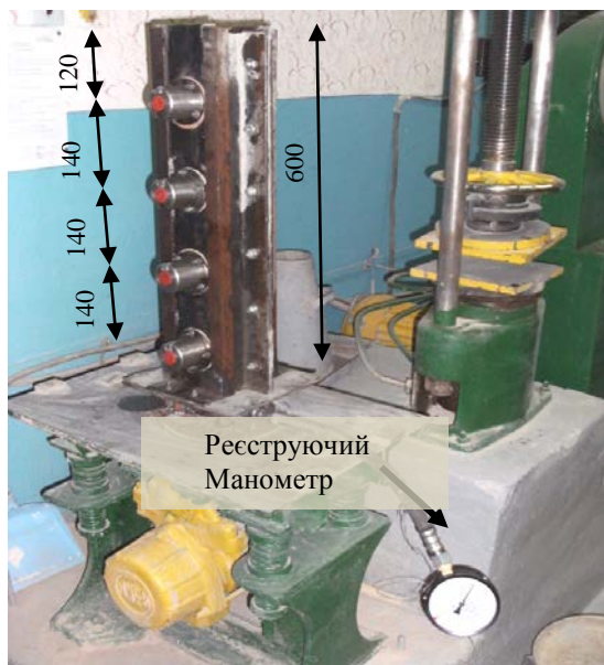
Рис. 1. Вібрууцільнення бетонної суміші на лабораторному вібростолі
