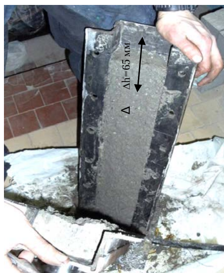
Рис. 2. Структура вібропресованого бетону складу К після розпалублення форми
