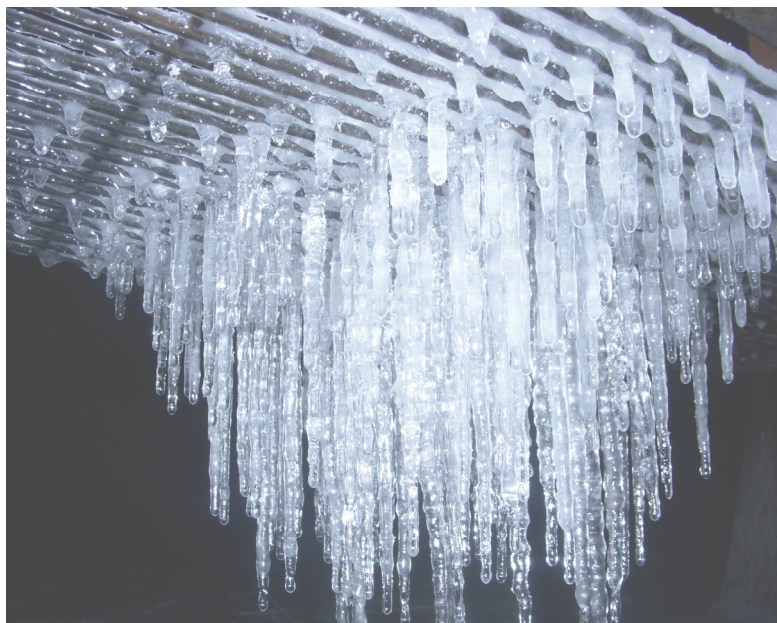
Вигляд насадок та бурульок після завершення експериментів
