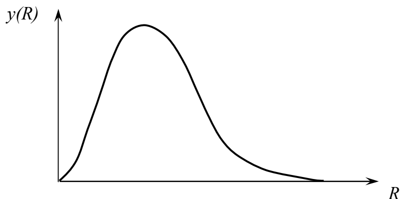
Рисунок 40 — Графік функції розподілу розмірів за законом Релея
