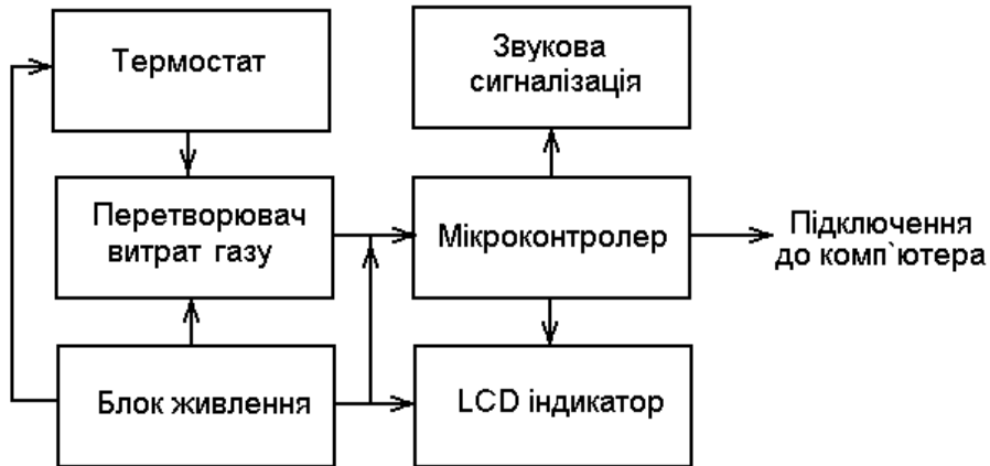
Рис. 5.1. Структурна схема вимірювального блока витрат газу
