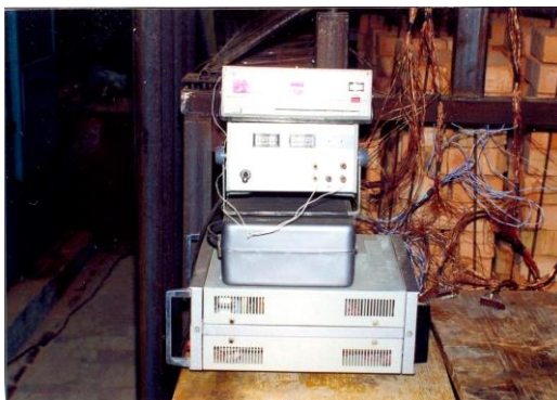
Рис. 4. Прилади для вимірювання відносних деформацій
