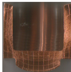
Рисунок 3.23 – Фотографії деформованих заготовок з М1 – кінцева стадія: а) схема без гідропідпору; б) схема з гідропідпором
