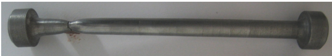
Рисунок 2.10 – Зразки із маловуглецевої сталі Ст3, здеформовані до різних ступенів деформації а) зр. № 1, б) зр. № 2; в) зр. № 3
