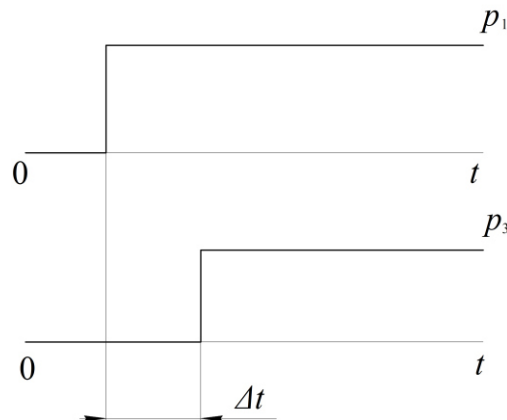
Рисунок 8.19 – Залежність величини тиску p_1 та p_3 від часу у випадку затримки за переднім фронтом сигналу керування
