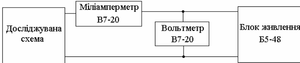
Рисунок 5 – Блок-схема вимірювальної установки для зняття ВАХ
