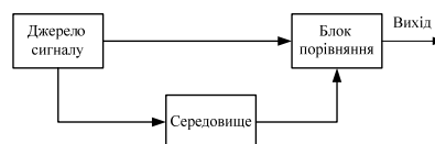
Рис. 1. Структурна схема двоканального сенсора
