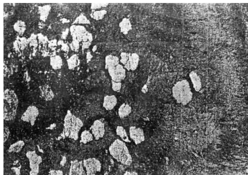
Рисунок 17 – Шиферність на поверхні злому
