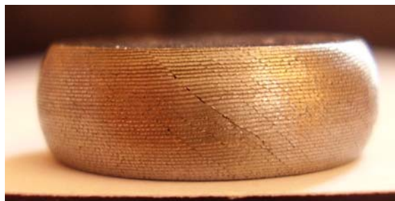
Рис. 1. Тріщина на бічній поверхні осадженого зразка
