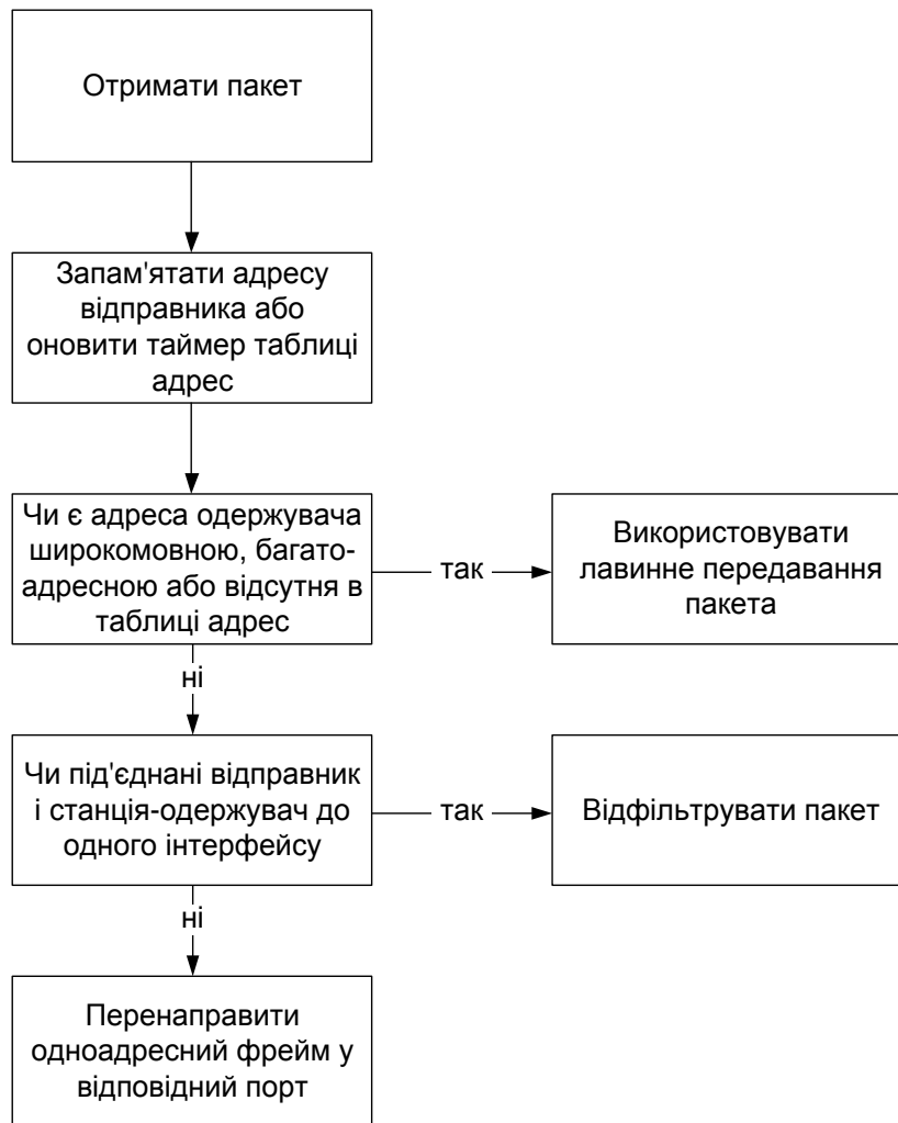
Рисунок 2.1 – Кроки методу прозорого мостового перенаправлення
