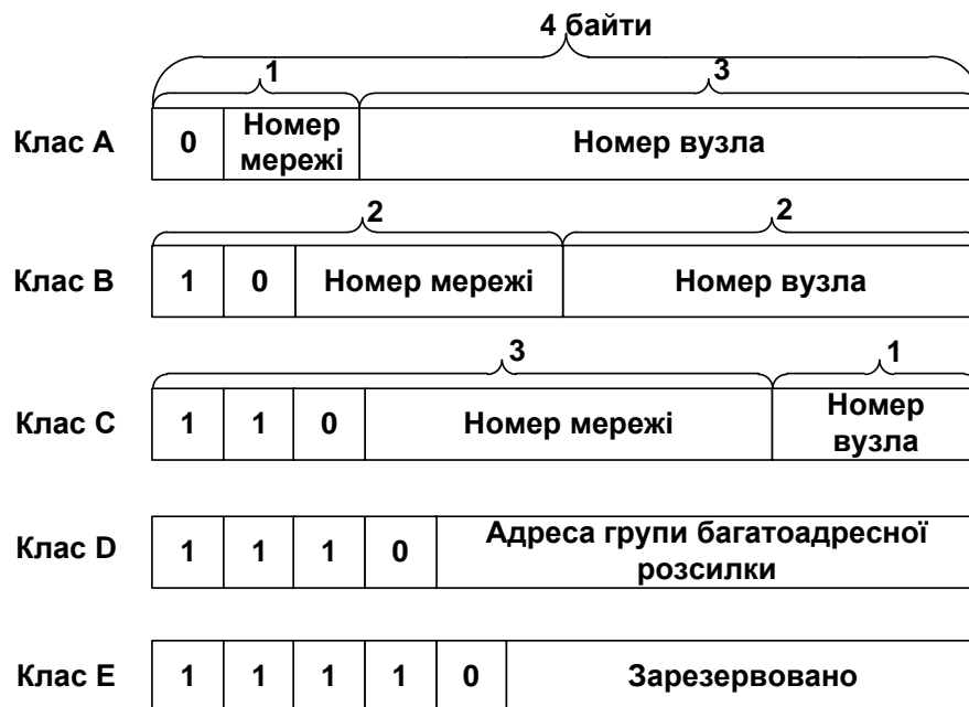
Рисунок 1.2 – Структура IP-адрес різних класів
