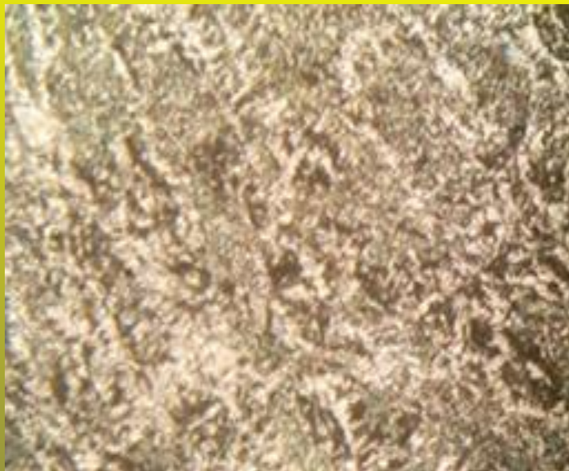
Структура наплавленного металла на сталь40X проволокою Ni-30Cr
