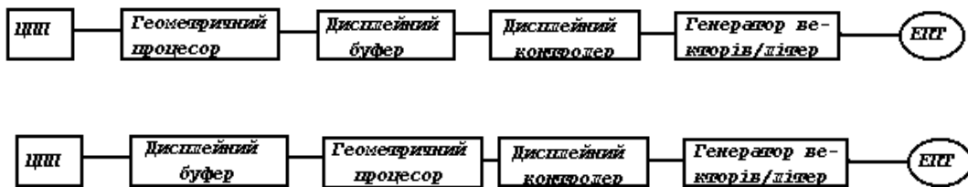
Рис.5.4. Концептуальні блок-схеми векторних дисплеїв з регенерацією.
