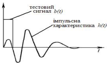
Рис. 8. Неправильний вибір ширини тестового сигналу
