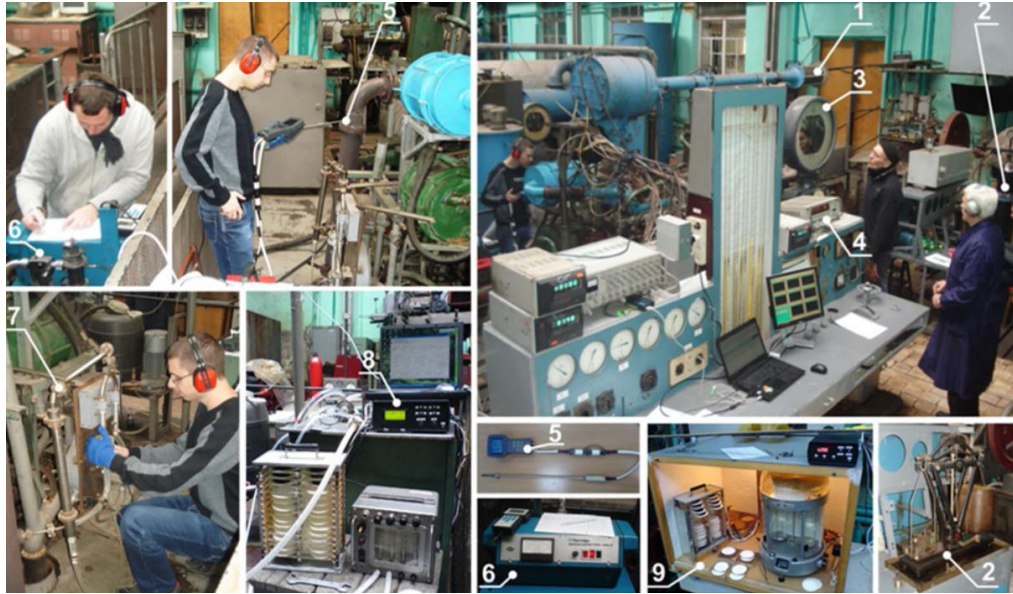
Рис. 1. Загальний вигляд випробувального стенду дизеля 4ЧН12/14 з універсальною системою екологічної діагностики:
