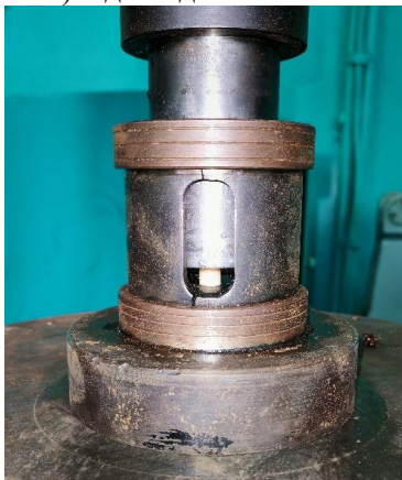
Рис. 1. Зразок із пломбувального матеріалу в устаткуванні для проведення випробувань.
