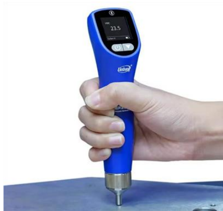
Рис. 2 – Портативний ультразвуковий твердомір Linshang LS256
