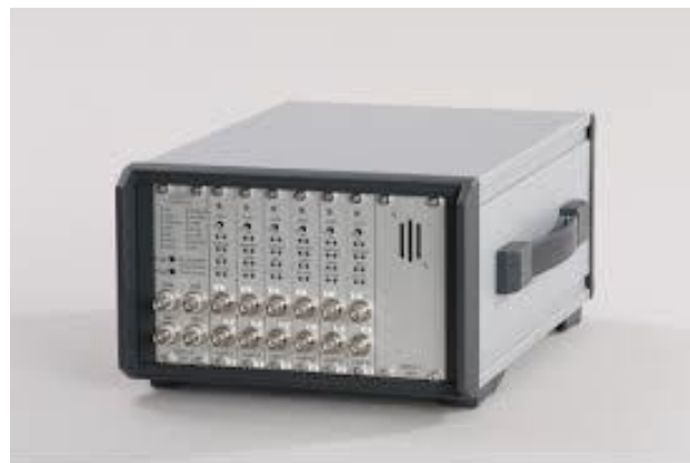
Рис. 5 - AMSY-6 Multi-Channel System - портативний прилад акустичної емісії
