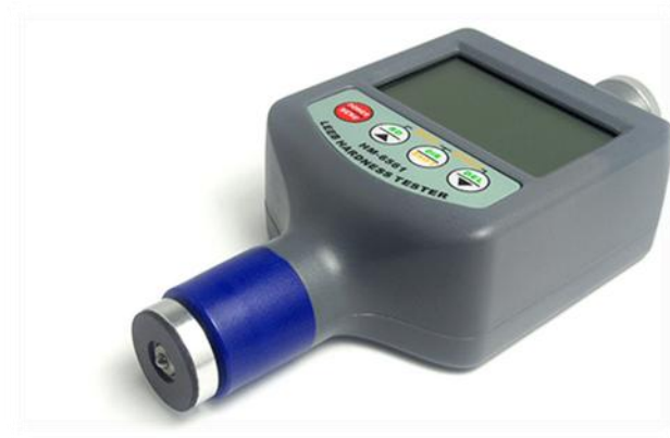
Рис. 1. – Твердомір за ударним динамічним методом Ліба HM-6561
