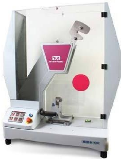
Рис. 4 – Instron CEAST 9050 — маятниковий копер для випробувань на ударну в'язкість
