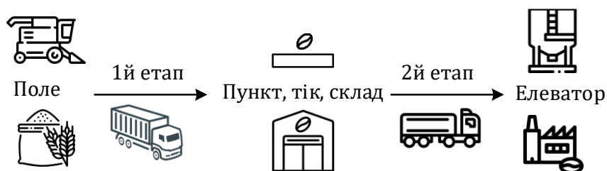
Рис. 3. Схема використання тимчасових пунктів зберігання для доставки зерна до споживача
