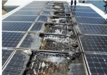
Рис. 31.2. Результати пошкодження ізоляції та контактних з'єднань.
