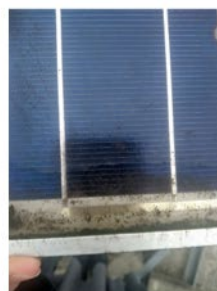
Рис. 30.1. Пошкодження каркасу ФЕМ (пошкодження герметика, пошкодження рамки, пошкодження кріплення).
