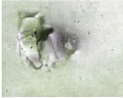
Рис. Б.4. Пошкодження EVA (пошкодження етилен-вінілацетатового покриття ФЕМ).
