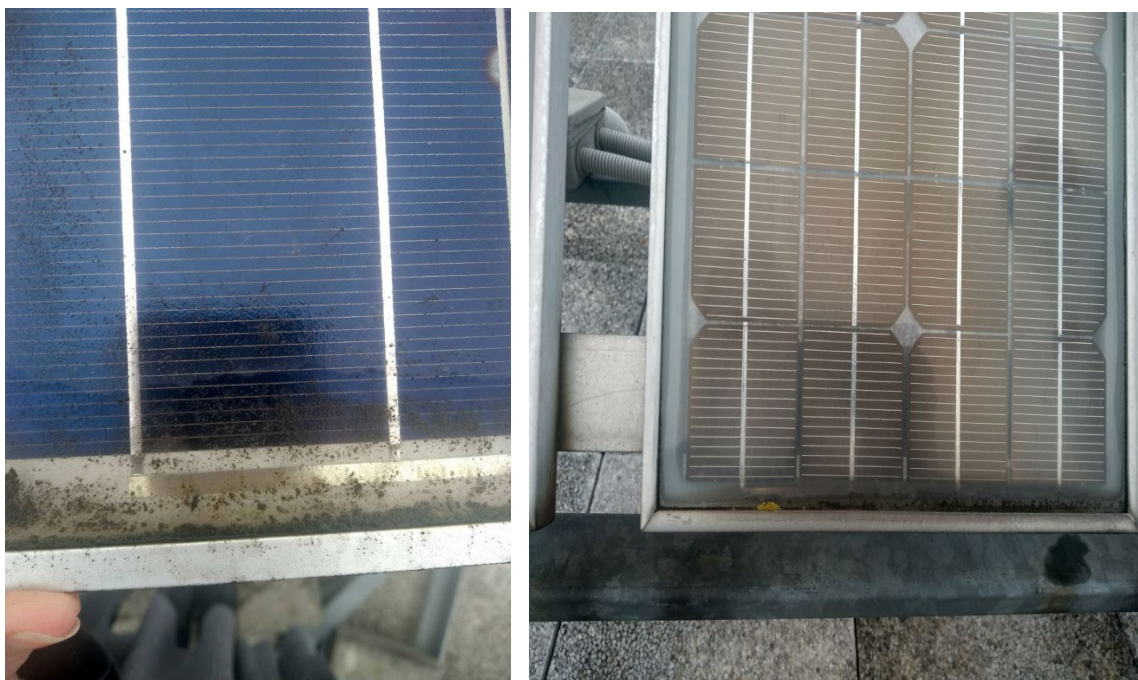
Рис. Б.11. Пошкодження герметика ФЕМ та склопакету.
