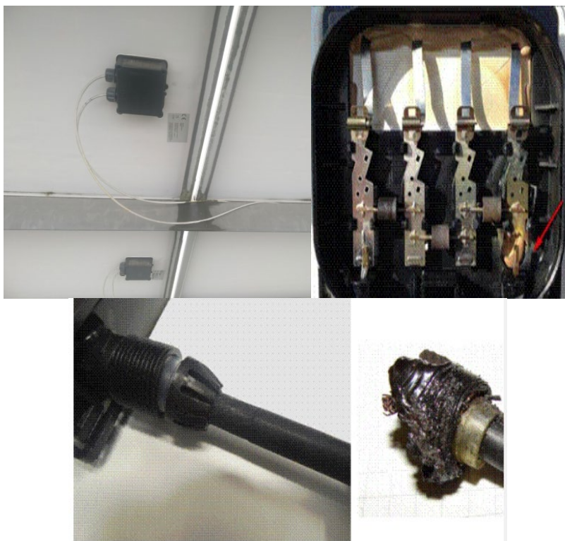
Рис. Б.15. Клемний термінал junctionbox – місце можливого перегріву.
