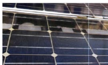
Рис. 26.2. Розшарування та деградація cells ФЕМ
