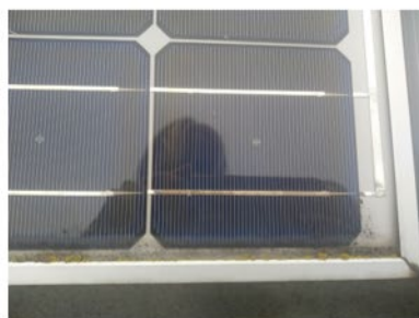
Рис. 30.1. Пошкодження каркасу ФЕМ (пошкодження герметика, пошкодження рамки, пошкодження кріплення).
