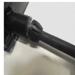
Рис. 31.2. Результати пошкодження ізоляції та контактних з'єднань.
