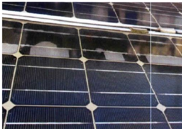
Рис. Б.1. Розшарування та деградація cells ФЕМ.
