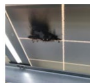
Рис. 30.5. Зростання опору та нагрів контактів в місці з'єднання cells між собою або пошкодження діоду Шоттки.
