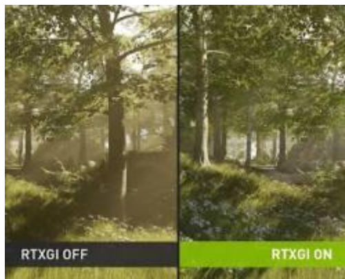
Рис. 3. Порівняння сцени без та з використанням технології глобального освітлення (Global Illumination).
