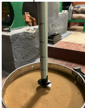
Рис. 1. Модельна гвинтова паля та схема її влаштування.
