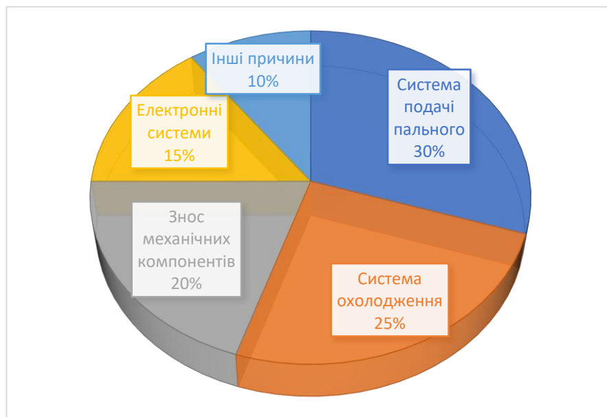
Рисунок 2 – Діаграма основних причин відмов систем дизельного двигуна
