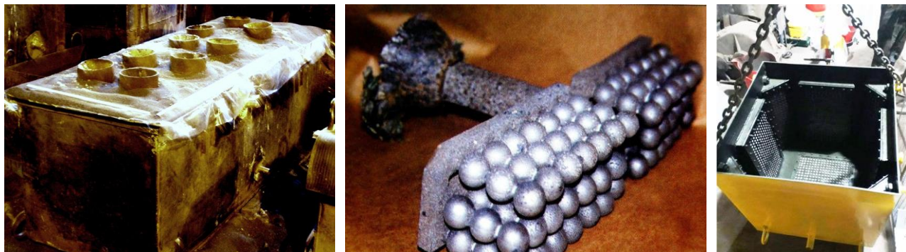
Рис. 2. Ливарна форма з кількома кластерами, вилиті кулі для млина, контейнерна опока з внутрішніми фільтрами
