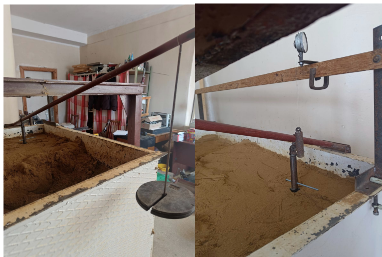
Рис. 3 – Система для передавання навантаження на одиночну палю
