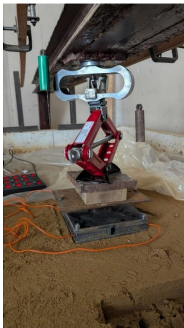
Рис. 2 – Система для передавання навантаження на модель пальового фундаменту
