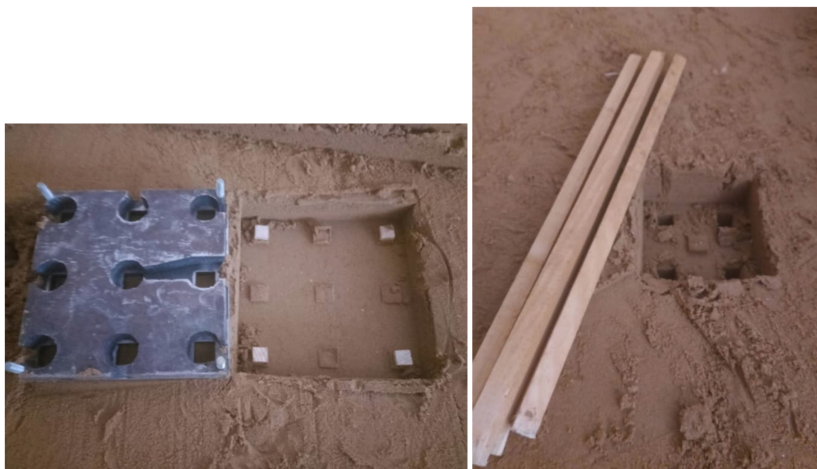
Рис. 1 – Розрізнене розміщення паль у тілі ростверків
