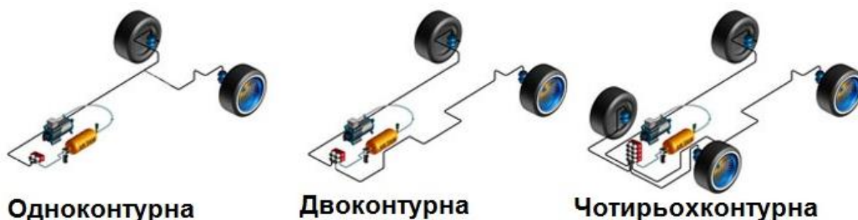
Рисунок 1 – Схеми типів пневматичних підвісок
