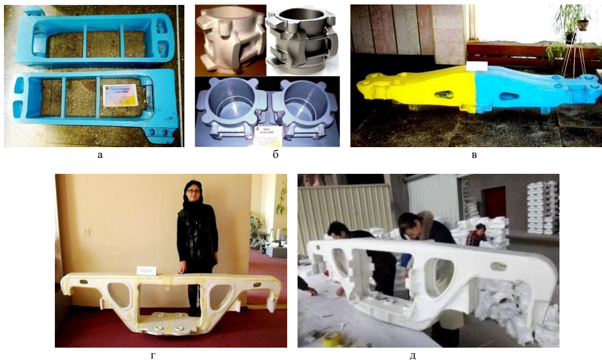
Рис. 2. Приклади виготовлення таких вагонних виливків: а - хомут тягловий; б - букса (модель та виливки у двох видах); в - надресорна балка; а також г, д - моделі бічної рами
