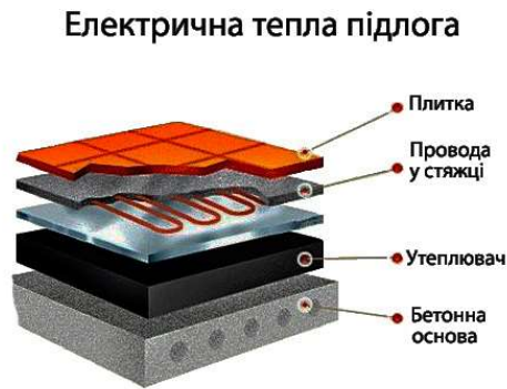
Рис. 2 – Конструкція електричної теплої підлоги
