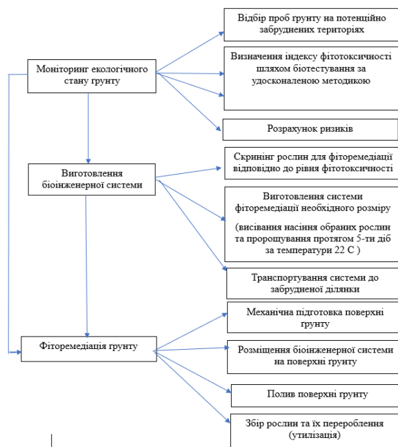
Рис. 35. Технологічна схема використання біоінженерної системи відновлення ґрунту на техногенно навантажених територіях
