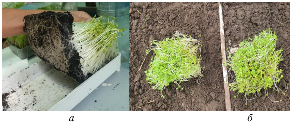
Рис. 35. Біоінженерна система відновлення ґрунту, забрудненого нафтопродуктами: а – сформований протягом п'яти діб газон; б – польові дослідження ефективності використання запропонованої біоінженерної системи очищення ґрунту від авіаційного керосину марки ТС-1
