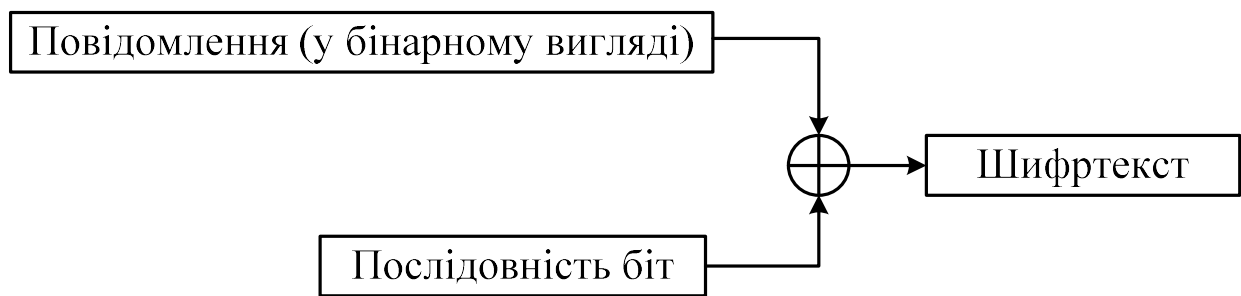
Рисунок 5.3 – Схема поточного шифру: додавання по модулю два відкритого тексту і послідовності біт дає шифр текст
