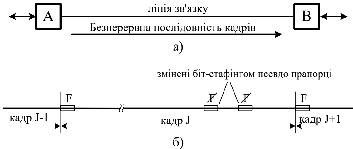
Рисунок 2.1 – Передача даних між пристроями А і В: а – схема; б – структура потоку бітів.
