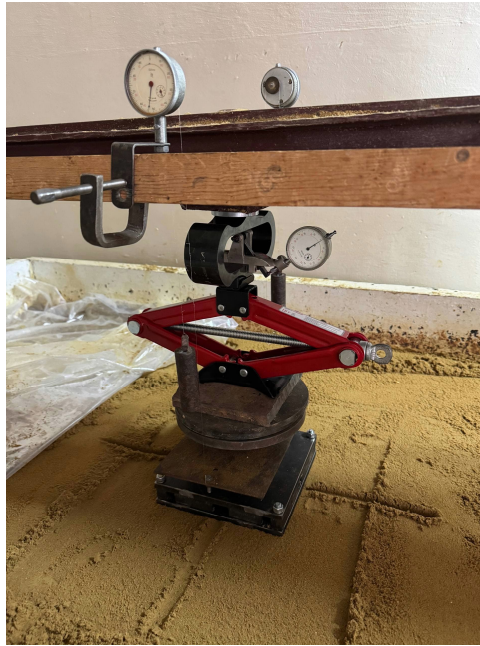
Рис. 2 – Система для передавання навантаження на модель ростверку (штамп) без паль
