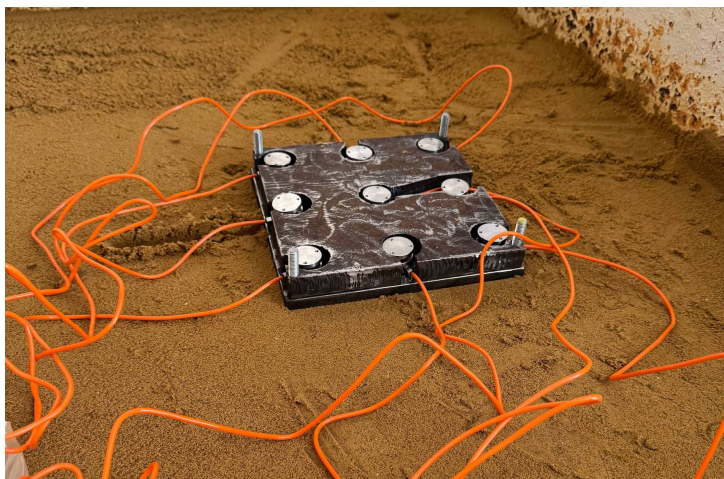
Рис. 1 – Розміщення датчиків у тілі ростверка
