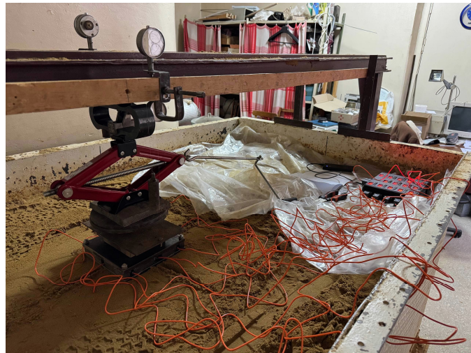
Рис. 3 – Система для передавання навантаження на модель пальового фундаменту
