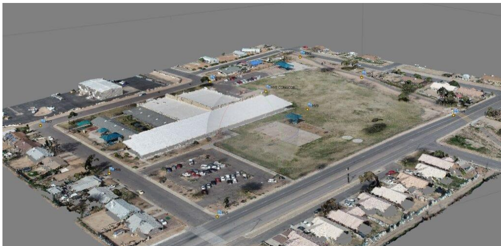
Рис. 1 – Приклад згенерованого 3D-середовища із використанням аеро-фотограмметрії у програмі Blender
